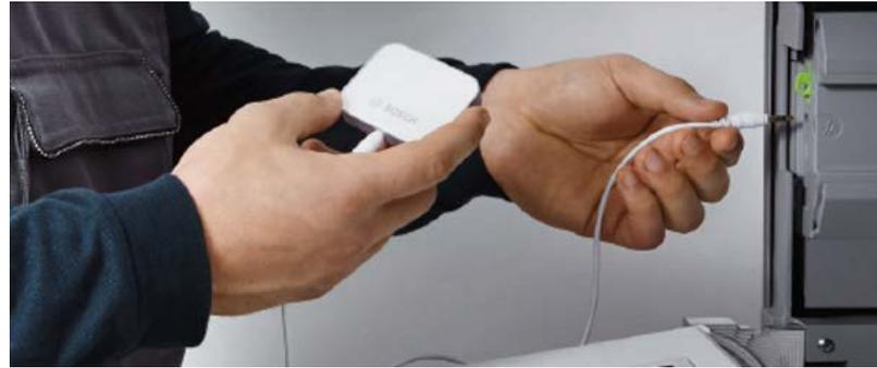
La clé de service intelligente est équipée d'un aimant puissant qui peut être fixé à la paroi métallique de l'appareil = facile.
