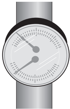
Fig. 40 Thermo/manomètre pour l'affichage de la pression de service et de la température de départ
