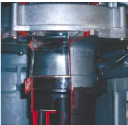
Obrázek 4: Kondenzační přístroj v klidu s uzavřenou „klapkou“ - pojistkou zpětného proudění
