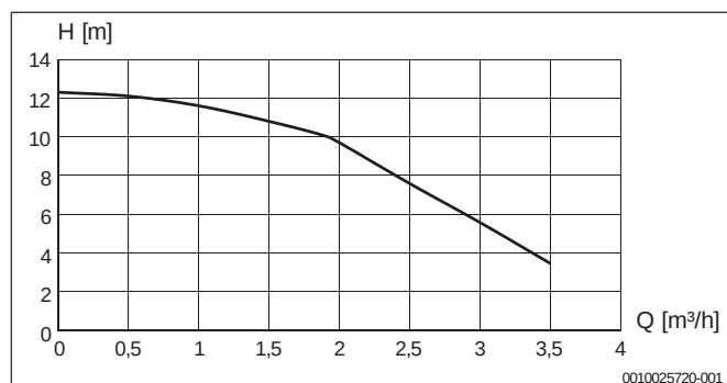
obr. 26 Charakteristika solankového čerpadla CS7800iLW 12 (F) (BHM) ... CS7800iLW 16 (F) BHM/CS7800iLW 12 M(F) ... CS7800iLW 16 M(F)
