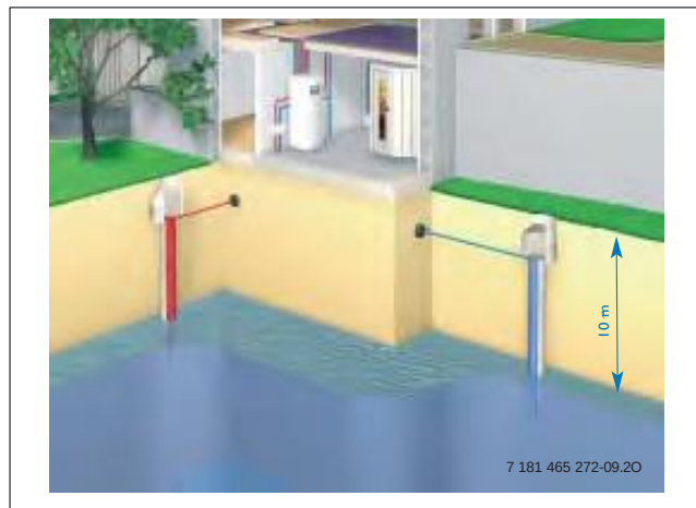
obr. 8 Studny spodní vody (rozměry v m)
