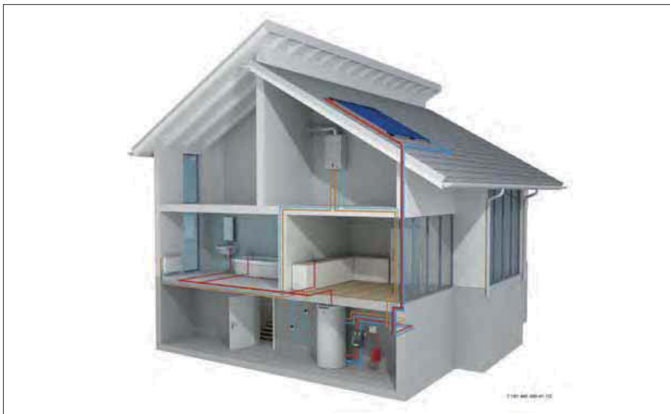
Obr. 8 Solární ohřev pitné vody s podporou vytápění
