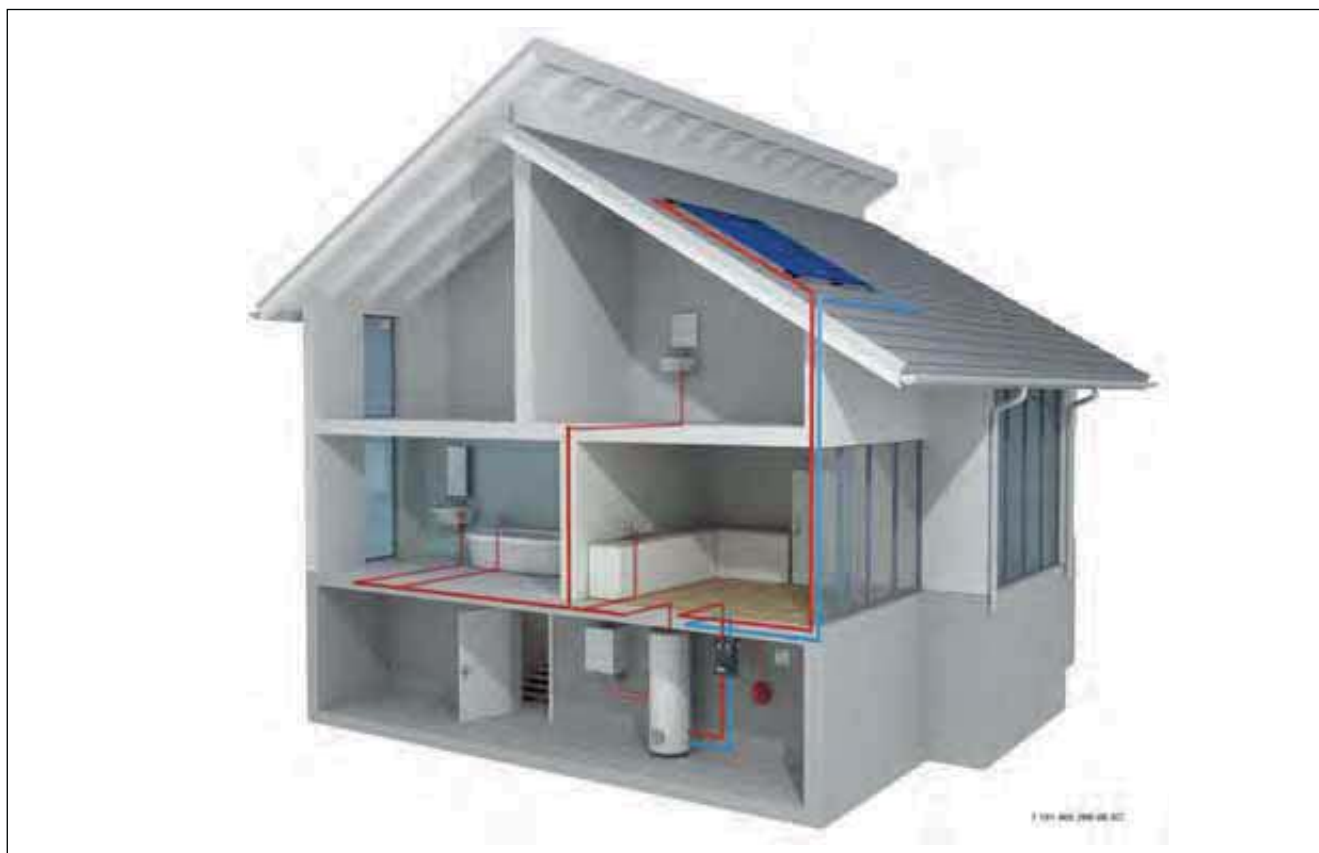
Obr. 7 Princip funkce solárního systému
