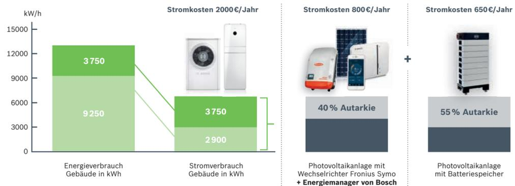
Annahme: 50 kWh/m<sup>2</sup>a Heizwärmebedarf, PV-Anlage mit 6,2kWp, 5,7 kWh Batteriespeicher (90% DoD), Strompreis 0,28€/kWh, Einspeisevergütung: 0,10€/kWh
