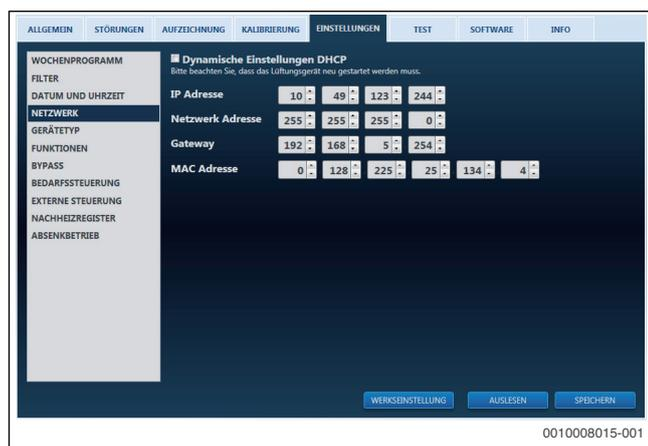
Bild 17 Netzwerkeinstellungen des Lüftungsgerätes
