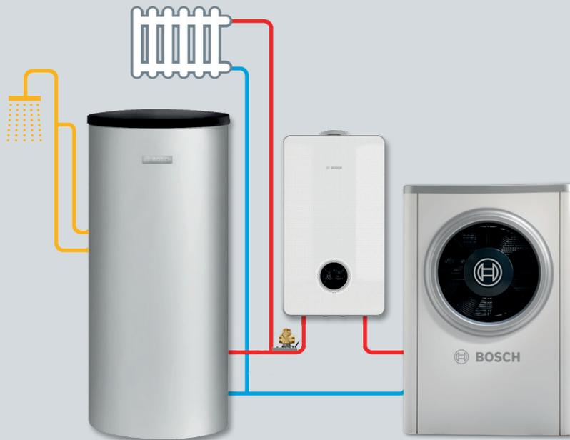
Hibridando, se puede reducir la potencia de máquina en uno o dos modelos frente a una solución de bomba de calor aire-agua 100%, la inversión inicial es más baja, se aprovecha la instalación existente, y aun así, se consiguen ahorros comprobados cercanos al 60% tanto en energía consumida como económicos, incluso en zonas frías.
