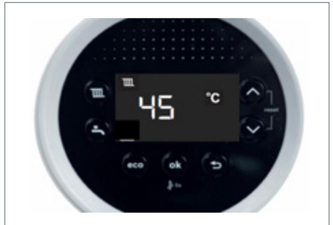
Operación de ajuste de temperatura de calefacción terminada.
