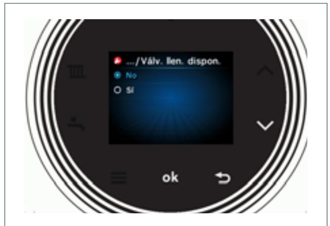
Seleccionamos Si y confirmamos con ok y en ese momento nuestra caldera Bosch **GC4700i** y el modelo **GC8700i** (recuerda es opcional), en caso de tener esta válvula de llenado inteligente esta será reconocida y preparada para funcionar y preparada para gestionar el llenado de una forma eficiente y **segura**.
