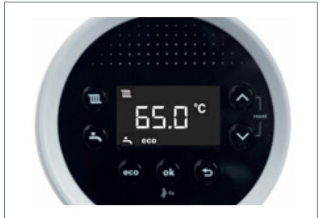
La caldera de fábrica viene preajustada para funcionamiento en ACS en modo **Confort**, para ajustar a modo **Eco**, pulsamos el **eco** en la pantalla mostrara la opción **eco** y a continuación validamos con ok.
