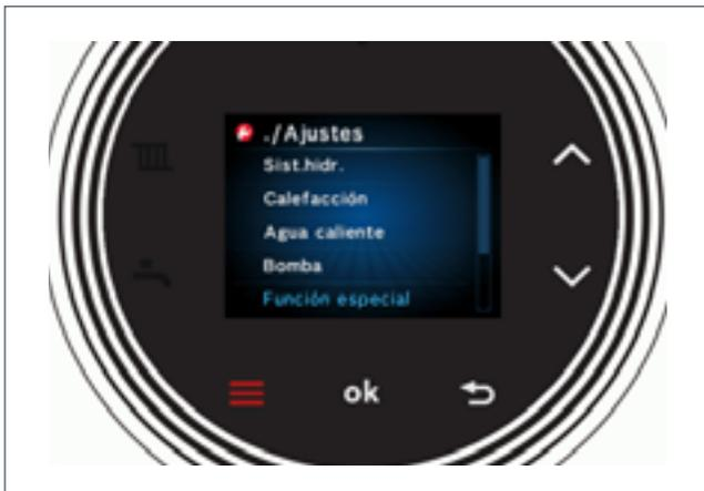
Una vez dentro del submenú de **Ajustes** navegaremos con las teclas ▲ o ▼.
