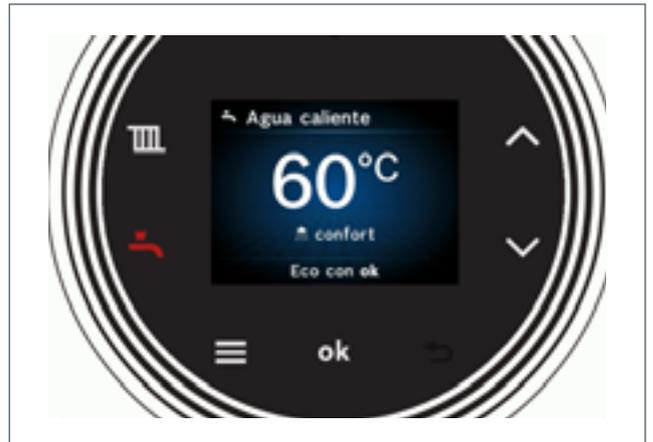
La caldera de fábrica viene preajustada para funcionamiento en ACS en modo **Confort**, para ajustar a modo **Eco**, pulsamos
