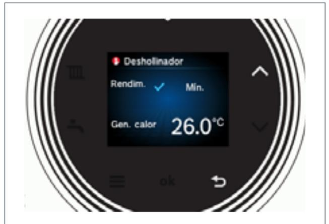
Fijar el modo análisis de combustión e iniciar el dispositivo a la mínima potencia térmica nominal.
