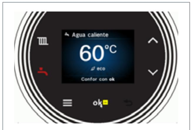
Ajuste de cambio a modo Eco para funcionamiento en ACS realizado.
