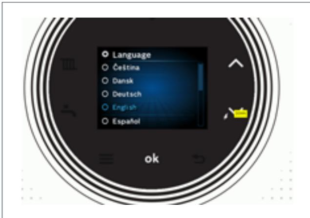
Conectar el aparato con el interruptor de conexión/desconexión, Ajustar el idioma durante la primera conexión del aparato.
