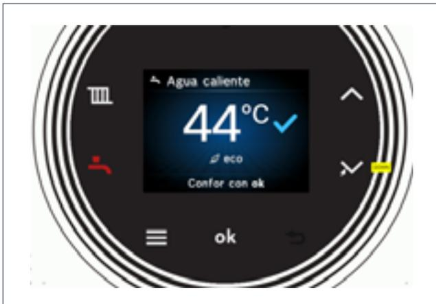
Operación de ajuste de temperatura de ACS terminada.
