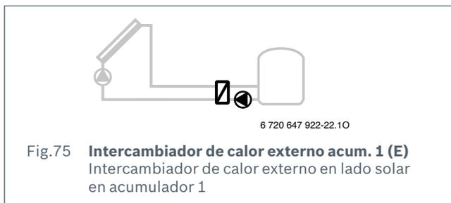
Fig. 75 **Intercambiador de calor externo acum. 1 (E)**
