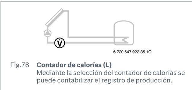
Fig. 78 **Contador de calorías (L)**
