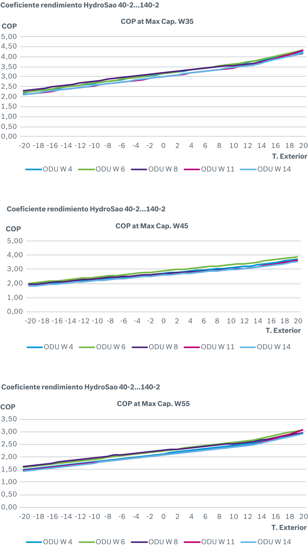
Fig. 39 Coeficiente de rendimiento (COP) SupraEco Hydro SAO 40-2... 140-2.
