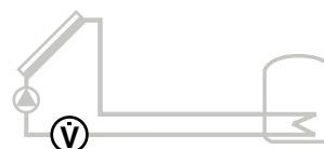
Fig. 80 Contador de calorías (L) Mediante la selección del contador de calorías se puede contabilizar el registro de producción.
