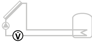
Fig. 92 Contador de calorías (L) Mediante la selección del contador de calorías se puede contabilizar el registro de producción.
