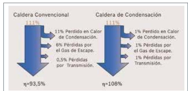
**Caldera convencional.** Partiendo de un 111% (considerando el poder calorífico superior), las mayores pérdidas son debidas al calor perdido o no recuperado de la no condensación de esta caldera, podemos hablar de un 11%. Las siguientes son las generadas por el gas de escape en la chimenea y suponen un 6%. Y por último un 0.5% debido a las pérdidas por transmisión. Contabilizando los resultados el rendimiento final de una caldera convencional quedaría en un 93,5%.
