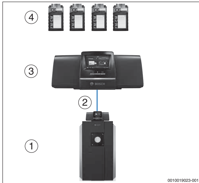
29. ábra CC 8311 vezérlőelektronika álló, idegen égős kazánokhoz
