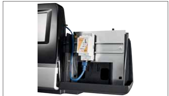
76. ábra IP-Gateway MEC Remote Plus (az FM-RM kalapsín modulra való szereléshez)
