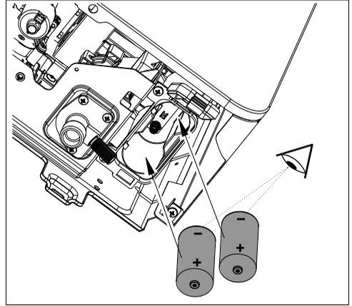
Fig. 4 Colocar las baterías
