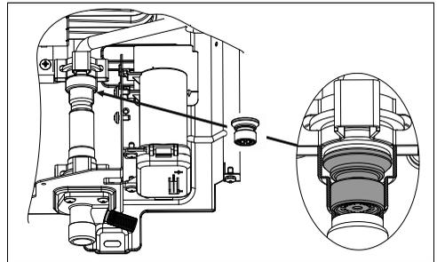
Fig. 20 Posicionamiento de regulador de flujo
