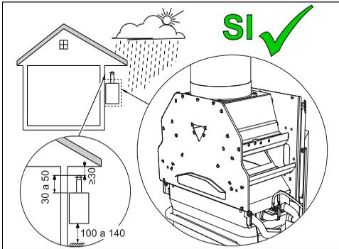
Fig. 11 Instalación ideal - con caseta de protección<sup>1)</sup>
