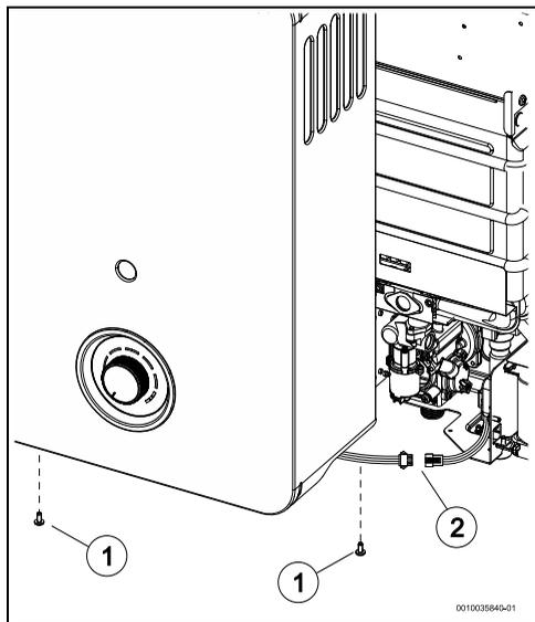
Fig. 24 Desmontar la carcasa
