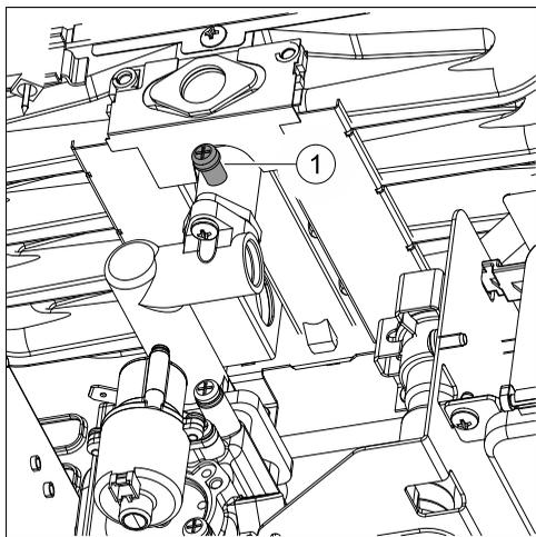
Fig. 23 Boquilla de medición para presión de toberas (7L)
