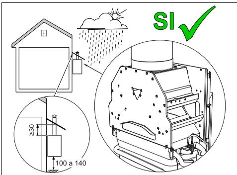
Fig. 12 Instalación sin techo, tejado básico
