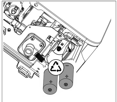
Fig. 5 Sustituir las baterías
