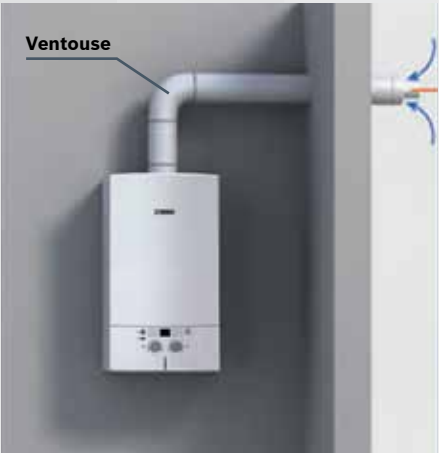
Accessoires de cheminée concentrique modèle AE La ventouse coaxiale utilisée sur les chaudières étanches AE permet d'évacuer les gaz brûlés à l'extérieur et d'absorber l'air nécessaire à la combustion des gaz.
