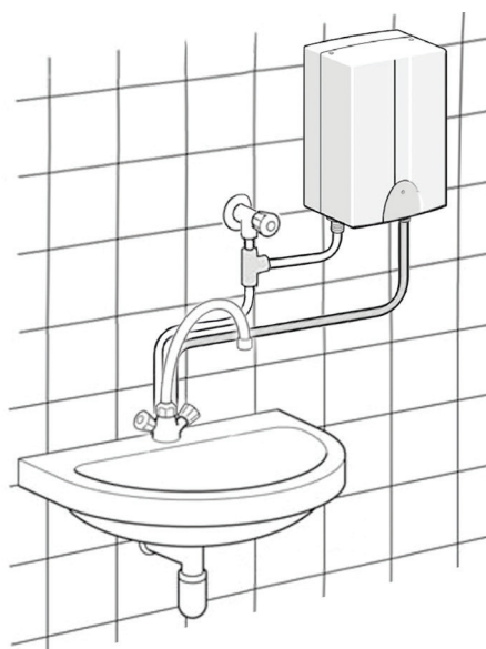
Installation Tronic 1000 B sur évier
