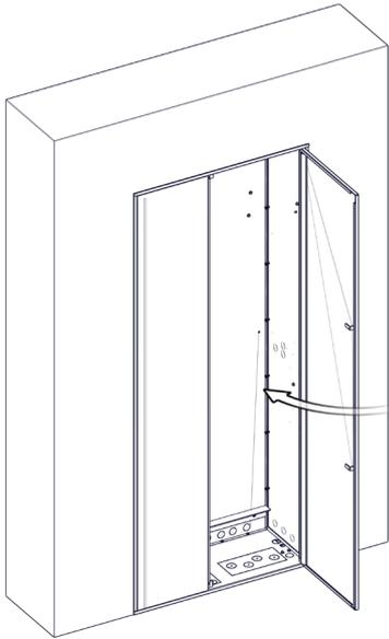
Consigliamo di tagliare già i pretranci per collegare poi i tubi dell'impianto. Chiudere completamente l'armadio tramite "chiave" in dotazione.
