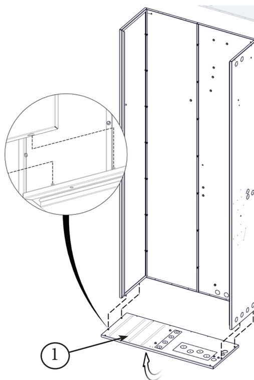
Poi fissarlo con le viti CH10x16. Fissare definitivamente le N°4 viti M5.
