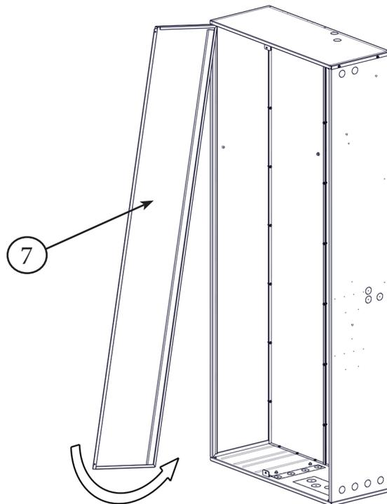
Fare scivolare l'anta SX sulla base verso la posizione finale in modo da allineare il piolo con molla, con foro del basamento.
