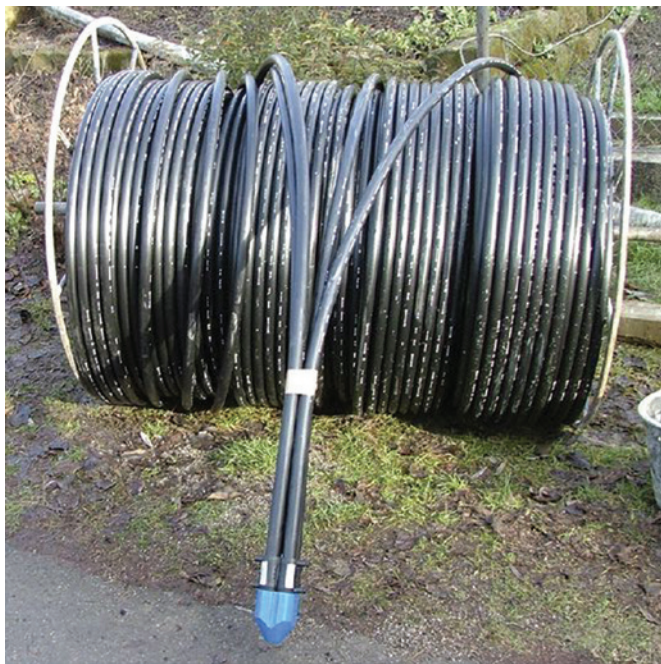
Rys. 11 Sonda geotermiczna ze stopką
