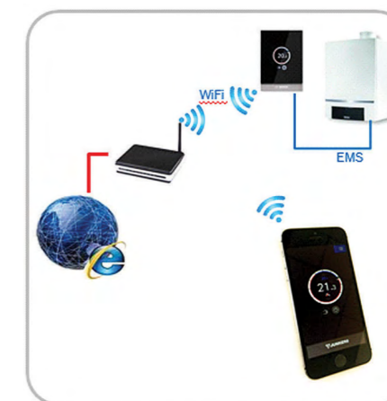
Za povezivanje regulatora CT100 nije potrebna fizička veza sa ruterom, već se veza uspostavlja preko Wireless konekcije
