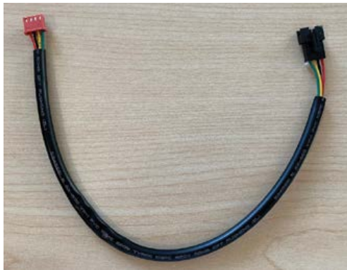
Figura 28 El cable de conexión E
