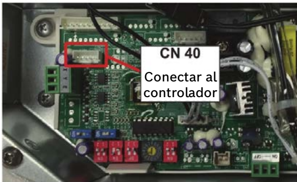
Figura 26 Ubicación del puerto CN40 para unidades 2 × 2 (9-18 K)
