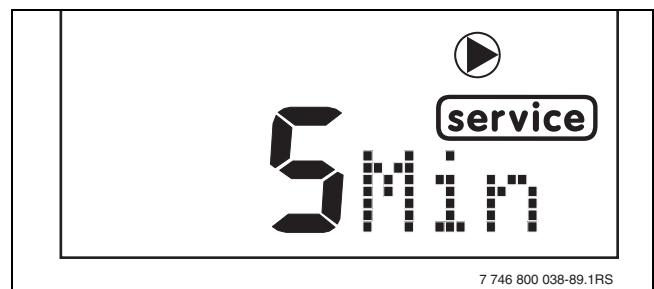
Fig. 65 Message affiché « Temporisation des pompes »
