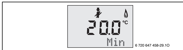
Bild 66 Min (= minimale Nennwärmeleistung) blinkt
