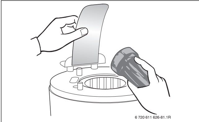
Bild 92 Wärmeblock auf Rückstände prüfen
