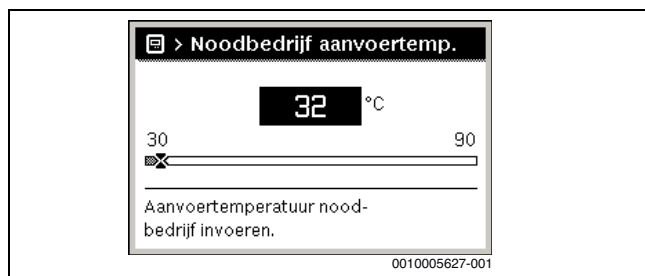
Afb. 48 Aanvoertemperatuur voor het noodbedrijf
