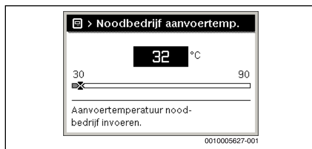
Afb. 13 Aanvoertemperatuur voor het noodbedrijf
