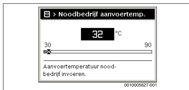
Afb. 30 Aanvoertemperatuur voor het noodbedrijf
