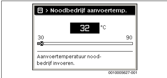
Afb. 10 Aanvoertemperatuur voor het noodbedrijf
